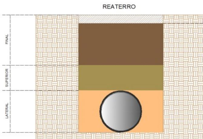
Figura 20: Camadas de reaterro conforme NBR 7367
